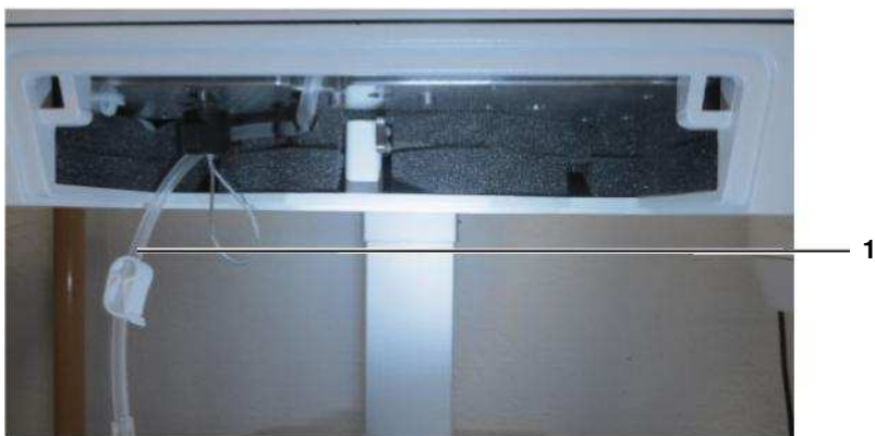
Fig. 78 Tubo de drenagem
