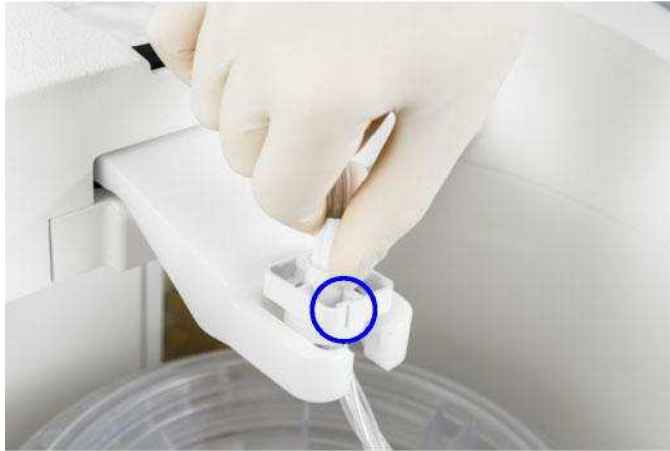
Fig. 34 Instalação do adaptador de centrífuga.
